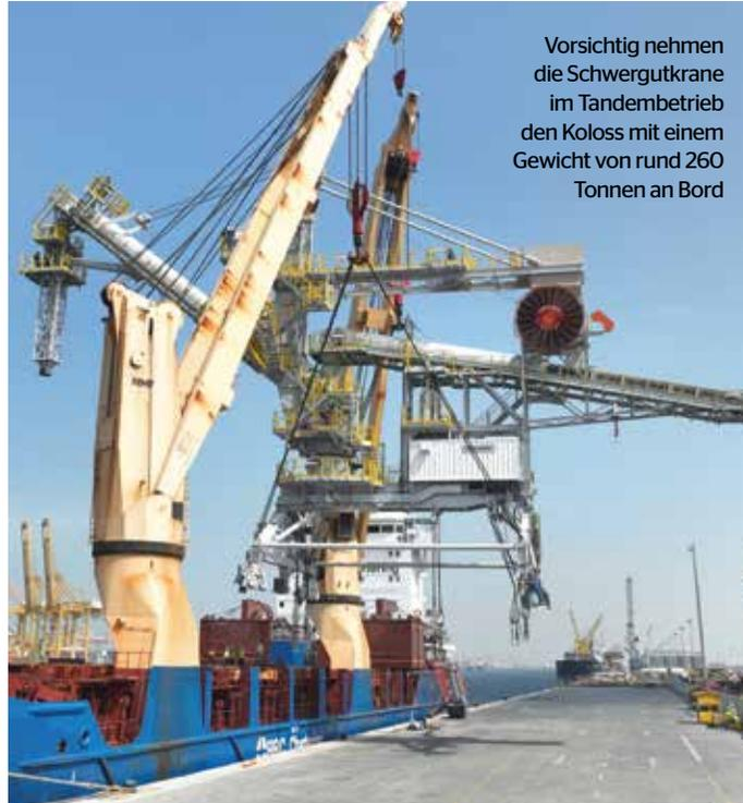
Vorsichtig nehmen die Schwergutkrane im Tandembetrieb den Koloss mit einem Gewicht von rund 260 Tonnen an Bord
