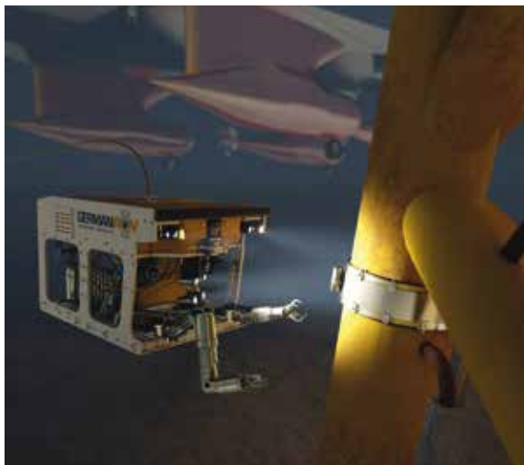
Inspektion am Fundament einer Offshore-Windkraftanlage
